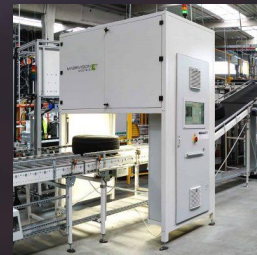
2D-Datacode Erkennung auf Reifen
